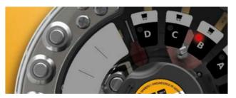
Achtung: Zur Umsetzung der Ausfallkontrolle, wird absichtlich ein geringer Strom an den Sicherungen vorbei zugelassen. Dieser Strom kann in einigen Situationen sehr kleine Verbraucher wie in Geräte eingebaute LEDs oder sonstige LED-Spots leicht zum Leuchten bringen, selbst wenn eine Sicherung durchgebrannt oder entfernt ist! Da dieser Strom auf etwa 1mA in 12V-Systemen bzw. bis zu 5mA in 48V-Systemen begrenzt ist, stellt dieses Phänomen kein Sicherheitsrisiko dar und ist völlig normal.
